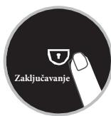
Dužim pritiskom na "Zaključavanje" od 3 sek da zaključate zaslon. Ponovnim pritiskom na tipku od 3 sek otključavate zaslon.
